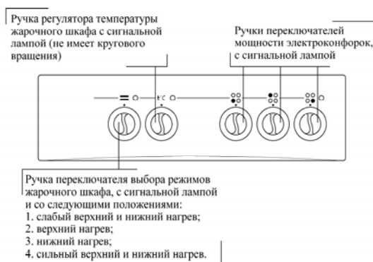
Рис. 7 Передняя панель плиты ЭПС301МС
